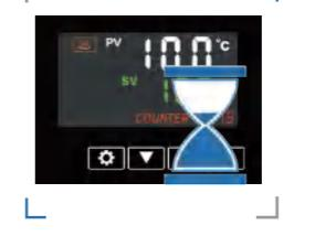
● **Удобный ЖК дисплей** Данный термопресс оснащен усовершенствованным ЖК-контроллером серии AT7000, обеспечивающим сверхточный контроль температуры и считывание показаний. Пользователь может настроить давление подачи с помощью настройки контроллера. Контроллер также оснащен функцией ожидания до 120 минут (режим P-5), что обеспечивает экономию энергии и безопасность.
